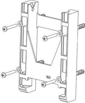
NOTA: No coloque la parte superior de la abrazadera a menos de 100 mm del techo.
