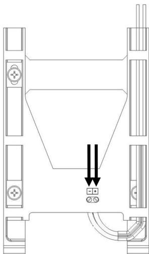
3. **LAUTSPRECHER IN HALTERUNGEN BEFESTIGEN** Setzen Sie die Lautsprecher von oben in die Halterungen ein. Nach dem Einsetzen rasten sie ein und können sich nicht mehr verschieben.
