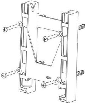
**HINWEIS:** Positionieren Sie die Oberseite der Halterung nicht weniger als 100mm von der Decke entfernt.
