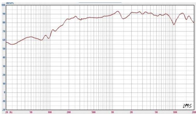
Grafico della risposta in frequenza: (dB SPL rispetto alla frequenza)
