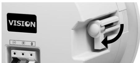
5. **APERTAR OS GRAMPOS** Da parte frontal do altifalante, vire os parafusos indicados abaixo. Os grampos de montagem sairão e apertar-se-ão automaticamente à laje do teto.
