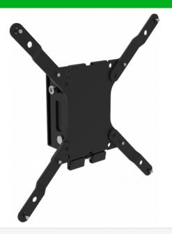
Os suportes da Vision para ecrãs planos (VFM) são robustos e simples de instalar. Este suporte é adequado para qualquer ecrã plano com configuração de montagem VESA padrão até VESA 200, com uma distância entre pontos de montagem de 200 x 200 mm. É também adequado para TV com configuração de montagem de 200 mm de largura x 100 mm de altura.
