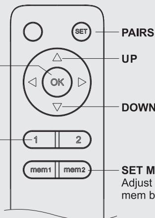
**PAIRS THE REMOTE TO CONTROL BOX**
