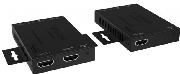
Il dispositivo TC-HDMIIP/V2 converte il segnale HDMI in pacchetti TCP/IP per la trasmissione su una rete LAN standard. Senza perdite visibili della qualità video, perfetto per applicazioni aziendali e di segnaletica digitale.
