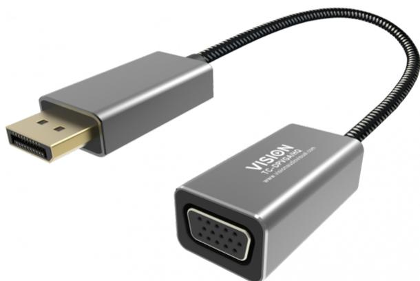
Liga-se à entrada DisplayPort do portátil e tem uma tomada VGA. O circuito ativo converte o sinal digital em sinal VGA analógico, para dispositivos de visualização que não possuem entrada digital.
